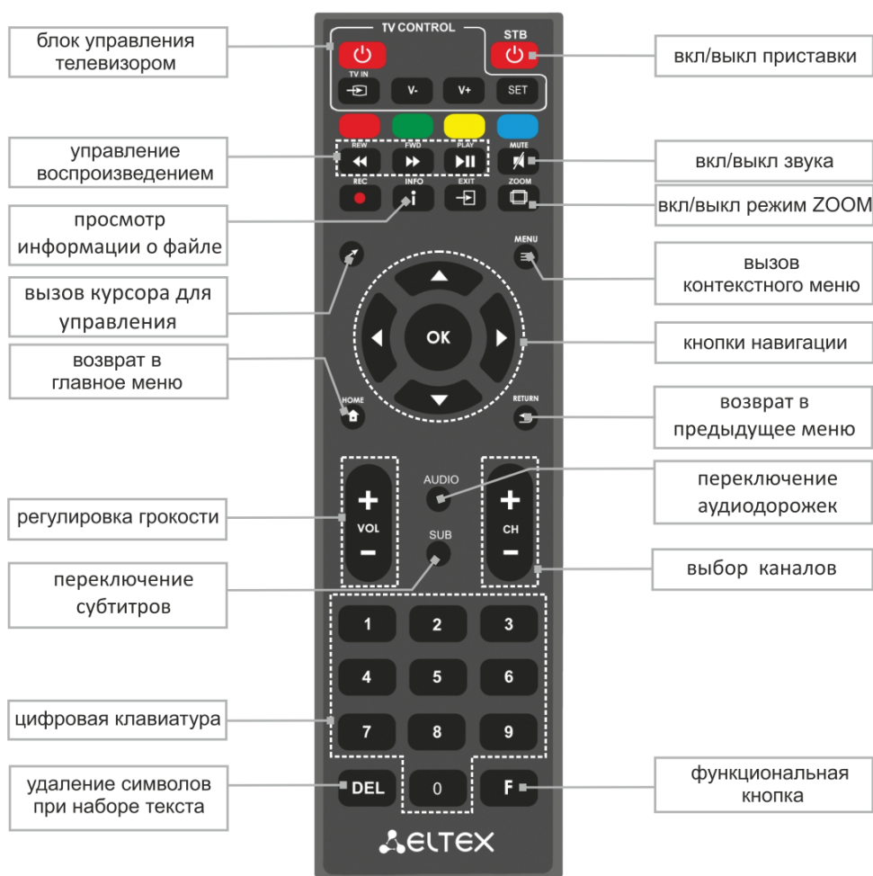
Рисунок 6 – Инфракрасный пульт для управления медиацентром и телевизором
